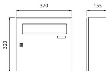
Abertura frontal para entrada de correio com tampa de protecção de chuva. Porta frontal para saída do correio com fechadura.
