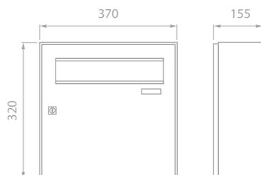
Abertura frontal para entrada de correio com tampa de protecção de chuva. Porta traseira para saída do correio com fechadura.
