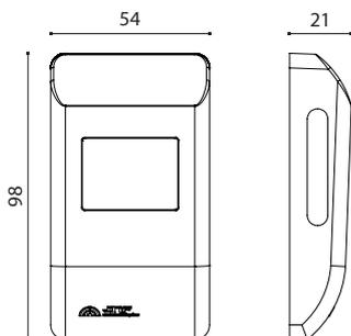
Fechadura electrónica para cacifos com cartão MIFARE. Permite funcionar em modo de auto-programação (o usuário escolhe o cacifo livre ficando associado até nova abertura). Funciona sem fios usando 4 baterias AA 1,5V. Sistema de alimentação de emergência. Sistema de leitura pode funcionar com cartões, porta-chaves ou pulseiras MIFARE.
